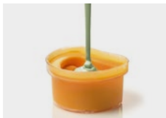
6. Заливка паковочной массы в силикон
