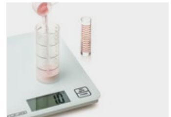
11. Взвесьте порошок пластмассы, отмерьте необходимое количество мономера и смешайте, сначала заливая мономер, а затем засыпая порошок
