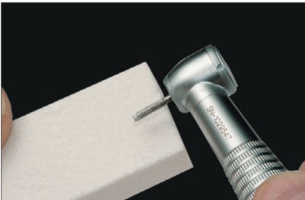
Проверить инструменты на загрязнение и по необходимости почистить. Чистить алмазные инструменты правильным камнем G9920. Check the instruments for contamination and clean, if required. Clean diamond instruments with the cleaning stone G9920.
