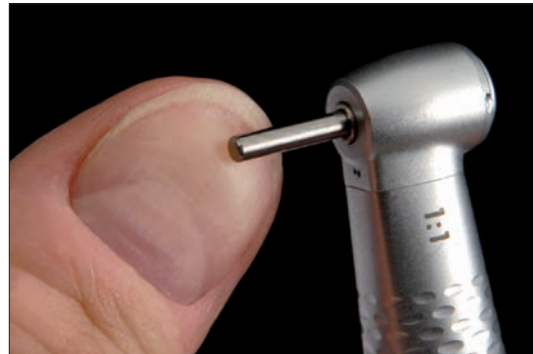
Проверка при помощи измерительного инструмента эталона – при вибрации турбина повреждена. Rotary check with test instruments – damage is indicated by vibrations.
