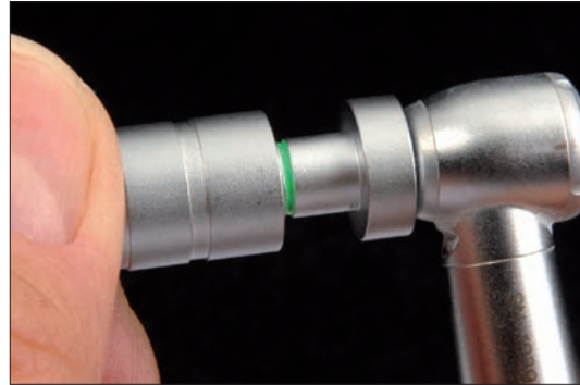
Проверка прибором для теста силы удержания. Check with a retention force tester.
